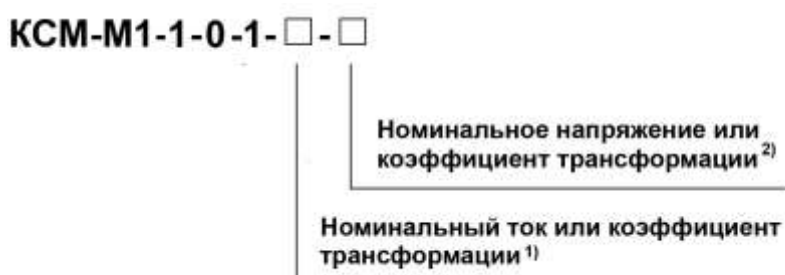
Рисунок 1.1 Структура условного обозначения модификаций приборов
