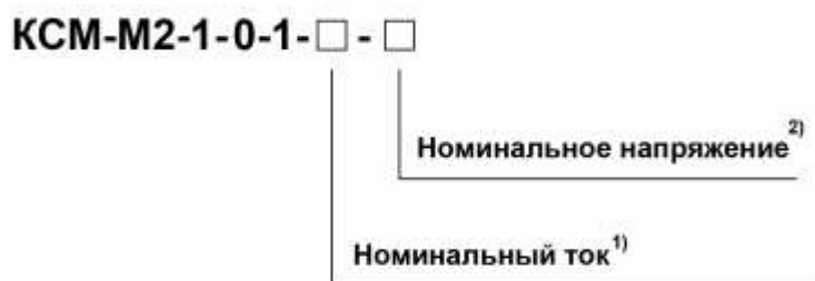
Рисунок 1.1 Структура условного обозначения приборов КСМ-М2
