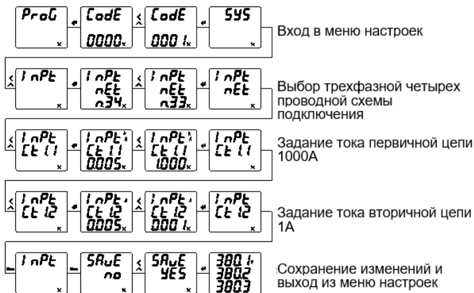
Рисунок 4.5 Установка системных параметров входных сигналов
