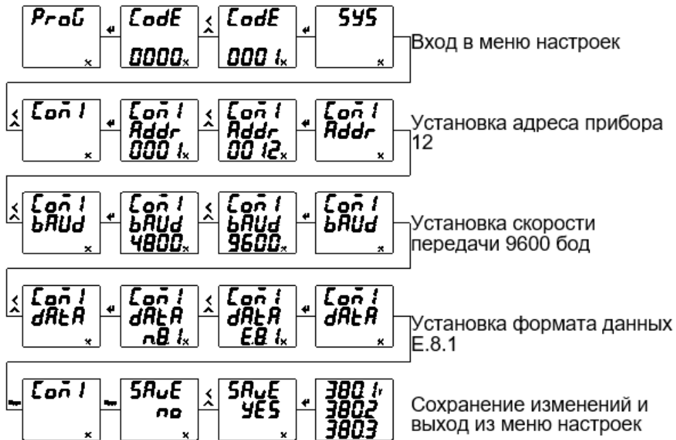
Рисунок 4.6 Настройка порта связи RS-485
