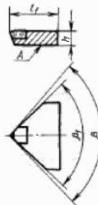
Допускается занижение плоскости А относительно кристалла алмаза на 0,1—0,3 мм.
