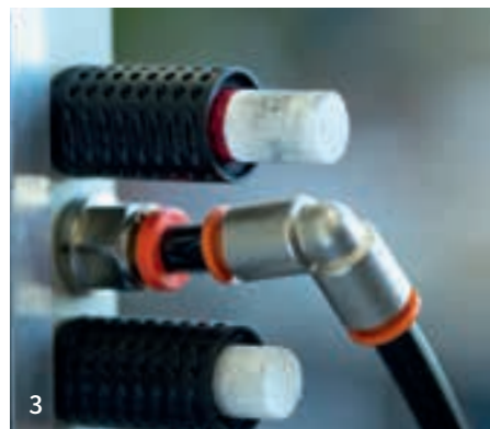
1. Изображение показывает глушитель в его нормальном положении.
