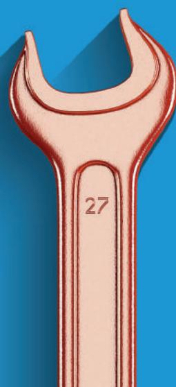
Омедненные инструменты предназначены работы в подземных выработках шахт и рудников, а также во взрывоопасных зонах помещений, наружных установок и сооружений, в которых возможно образование взрывоопасных смесей газов и паров с воздухом категорий I, IIA, IIB, IIC. Медное покрытие позволяет смягчать удары и препятствовать искрообразованию.
