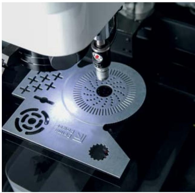
Оптический датчик с большим полем зрения и цифровым увеличением, позволяет оперативно проводить замеры и выводить полученные результаты в протокол измерений.
