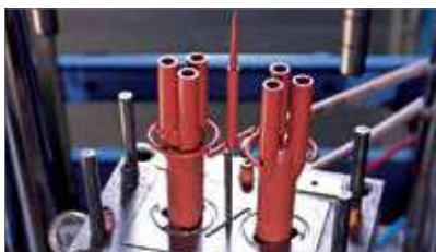
Производство термоусаживаемых перчаток
