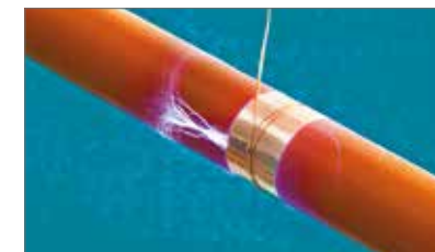
Определение электрической прочности материалов
