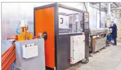
Линии для экструдирования термоусаживаемой трубки
