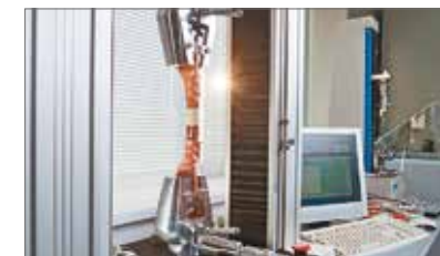
Испытания наконечников на разрывное усилие
