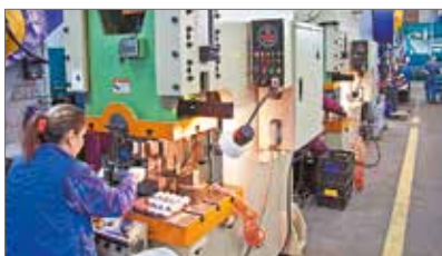
Производство болтовых соединителей и наконечников
