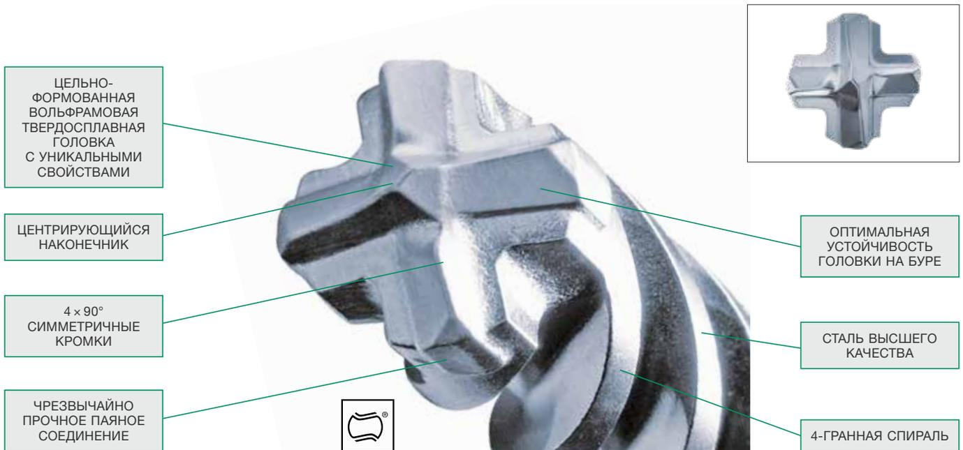
Самое последнее поколение буров Hitachi SDS-MAX разработаны для очень интенсивного использования, требующего высочайшей производительности. Такая динамичная конструкция с улучшенными характеристиками продлевает срок службы, значительно ускоряет работу и делает бурение более удобным. 4 симметричные режущие кромки гарантируют мягкое и плавное погружение в материал, обеспечивая в результате идеально круглое отверстие.
