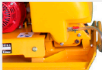
Виброплиты серии RPT оснащены литым чугунным основанием и имеют низкую степень износа.
