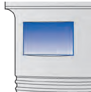
利用刀体上的平衡面进行预平衡
