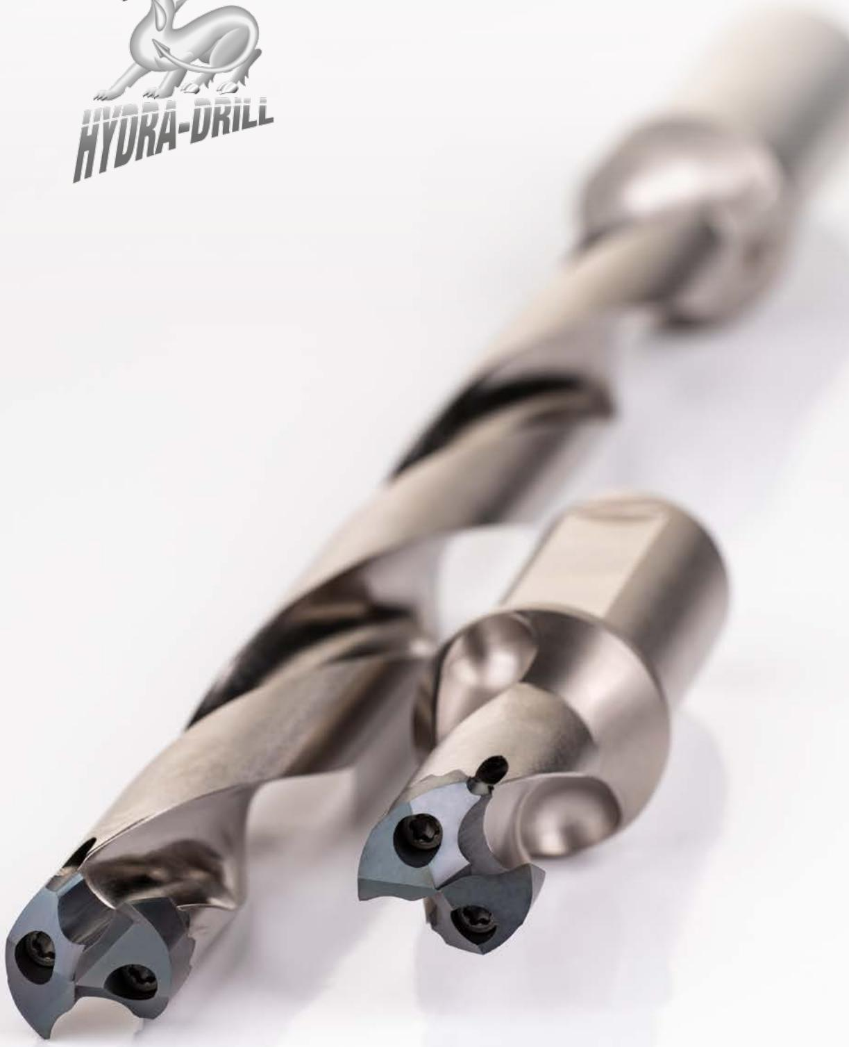
Ассортимент сверл Hydra со сменными твердосплавными головками пополняется новыми корпусами  $12 \times D$  для более глубокого сверления и  $1,5 \times D$  для повышения жесткости при сверлении неглубоких отверстий и листовых заготовок.
