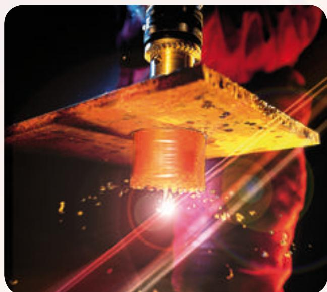
Державки Power Driver™ позволяют кольцевым пилам работать стабильно, равномерно распределяя все силы резания.
